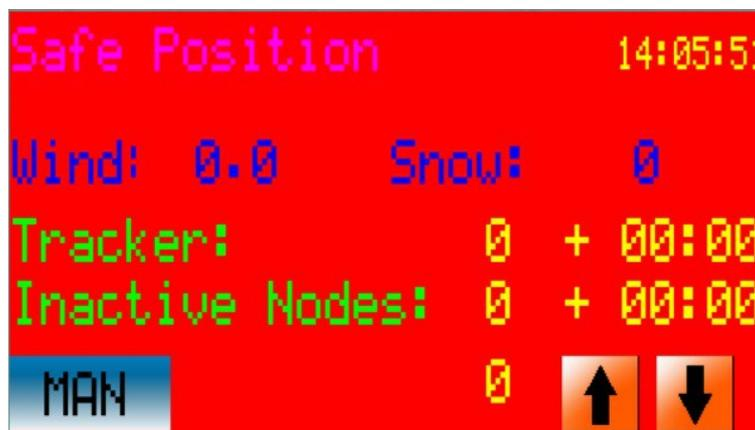
E' possibile, ad esempio, abbinare la prima posizione di sicurezza alla velocità del vento misurata da un anemometro, al superamento della soglia viene abbandonato il ciclo automatico e tutti i pannelli vengono posizionati nella relativa posizione di sicurezza.
