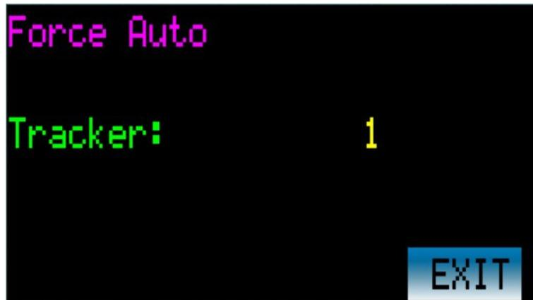
Il tasto di EXIT consente di abortire la procedura ed entrare nel ciclo automatico. ATTENZIONE: se la procedura non è completata gli ultimi tracker possono trovarsi in MANUALE e non seguire la posizione inviata dal PLC, E' possibile controllare lo stato di ogni tracker entrando nella procedura MANUALE del PLC.
