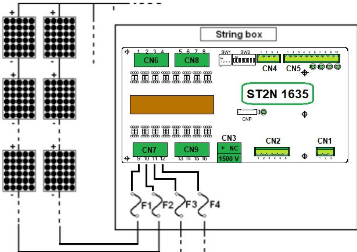
Subito dopo la morsettieria di ingresso delle stringhe, sulla scheda ST2N sono presenti 2 resistenze in parallelo, necessarie a rilevare il passaggio di corrente :
