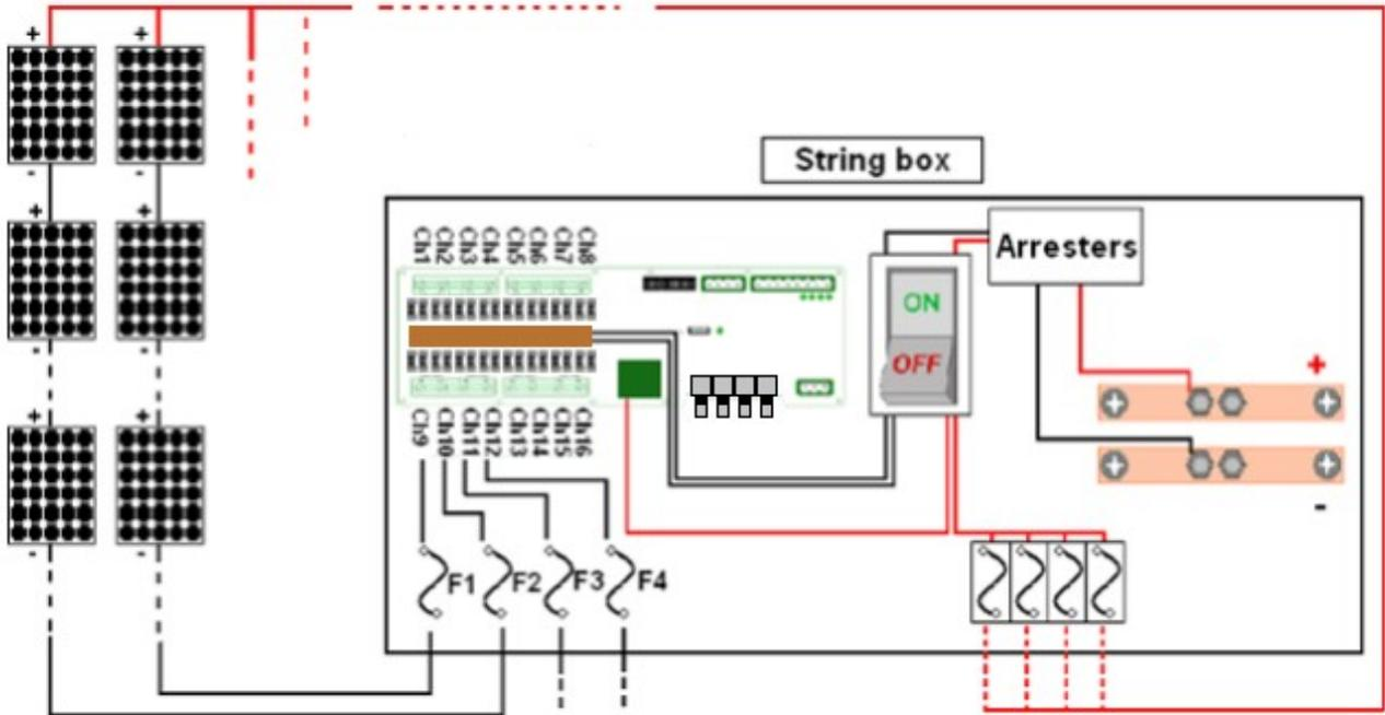
Nell'immagine seguente si vede il "Controllo di Stringa ST2N" con tutti i collegamenti. Chiaramente non è strettamente necessario collegare tutti gli elementi riportati in figura, essi sono solamente indicati per fornire un'idea generale dei collegamenti.
