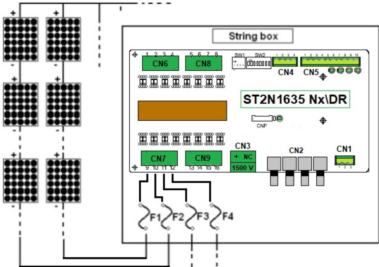
Subito dopo la morsettiera di ingresso delle stringhe, sulla scheda ST2N sono presenti 2 resistenze in parallelo, necessarie a rilevare il passaggio di corrente :
