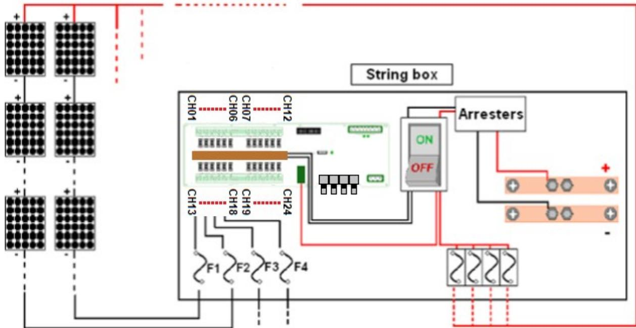
Nell'immagine seguente si vede il "Controllo di Stringa STON" con tutti i collegamenti. Chiaramente non è strettamente necessario collegare tutti gli elementi riportati in figura, essi sono solamente indicati per fornire un'idea generale dei collegamenti.
