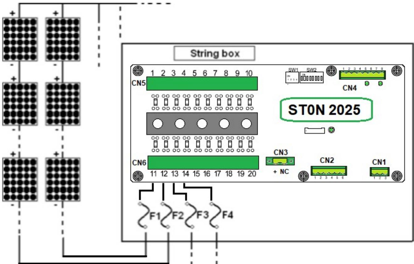
Subito dopo la morsettiere di ingresso delle stringhe, sulla scheda STON è presente una resistenza, necessaria a rilevare il passaggio di corrente :
