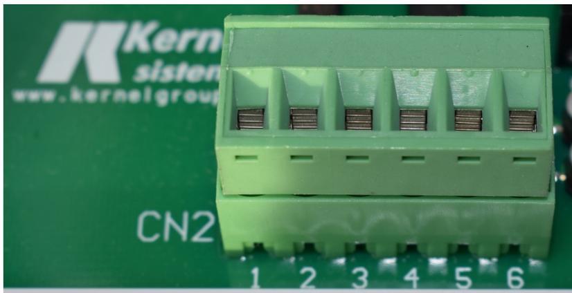
Sono presenti dei bridge, all'interno delle schede, per semplificare il cablaggio della RS485.
