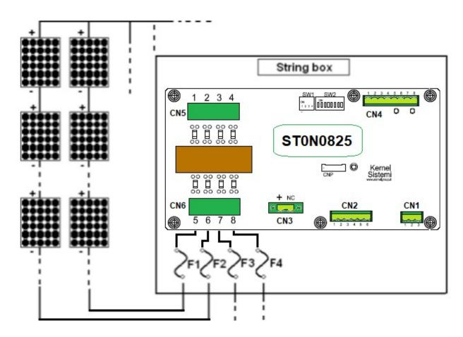
Subito dopo la morsettiera di ingresso delle stringhe, sulla scheda STON è presente una resistenza, necessaria a rilevare il passaggio di corrente :
