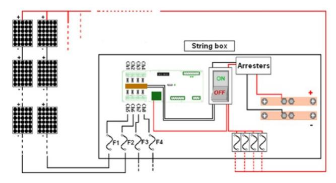
Nell'immagine seguente si vede il "Controllo di Stringa STON" con tutti i collegamenti. Chiaramente non è strettamente necessario collegare tutti gli elementi riportati in figura, essi sono solamente indicati per fornire un'idea generale dei collegamenti.
