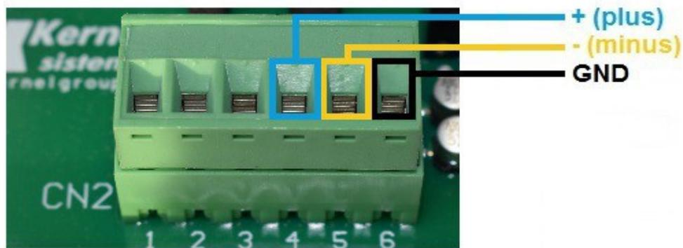
Sono presenti dei bridge, all'interno delle schede, per semplificare il cablaggio della RS485.
